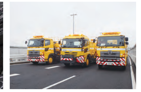
荷重車を用いた載荷による 補強後の安全性確認
