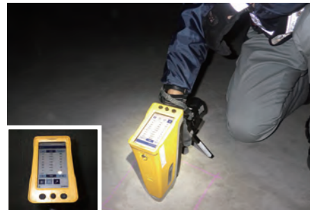
蛍光X線分析による塩分量測定
