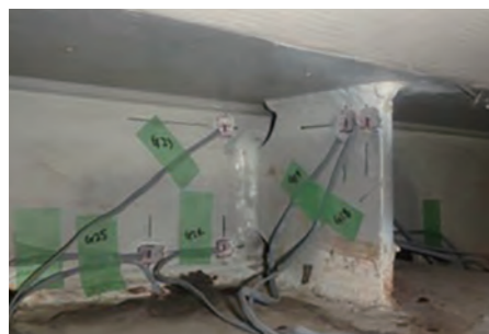
鋼桁の応力モニタリング (主桁・横桁交差部の応力計測状況)
