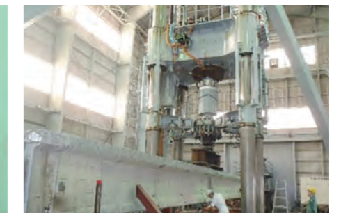
撤去した PC 桁の載荷試験
