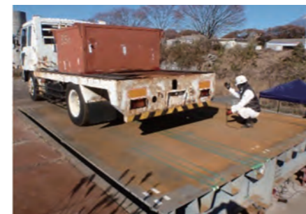
鋼床版の静的載荷試験
