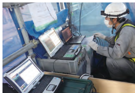
鋼桁の応力モニタリング (主桁・横桁交差部の応力計測状況)
