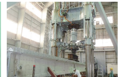
撤去した PC 桁の載荷試験
