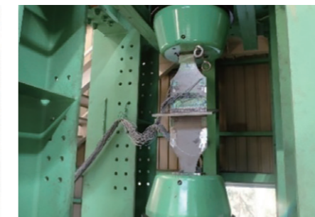
溶接継手部の疲労試験
