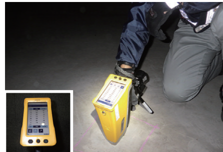
蛍光X線分析による塩分量測定
