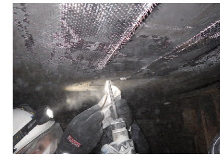
火災により被害を受けた RC 床版 (ドリル法による中性化測定)
