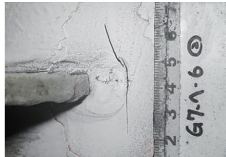
磁気探傷試験(鋼桁ガセット溶接部に発生した疲労き裂)
