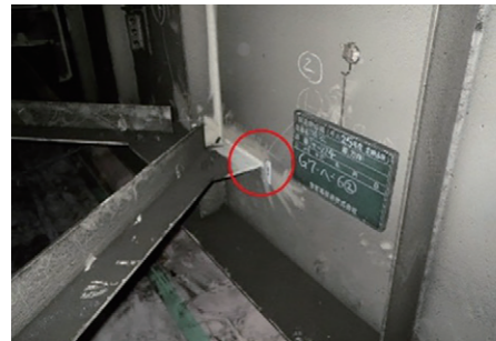
磁気探傷試験(鋼桁ガセット溶接部に発生した疲労き裂)
