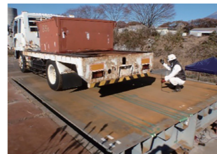
鋼床版の静的載荷試験
